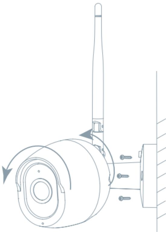
1. Pripevnite kameru k stene pomocou skrutiek
