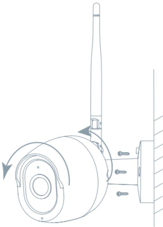
1. Připevněte kameru ke zdi pomocí šroubů
